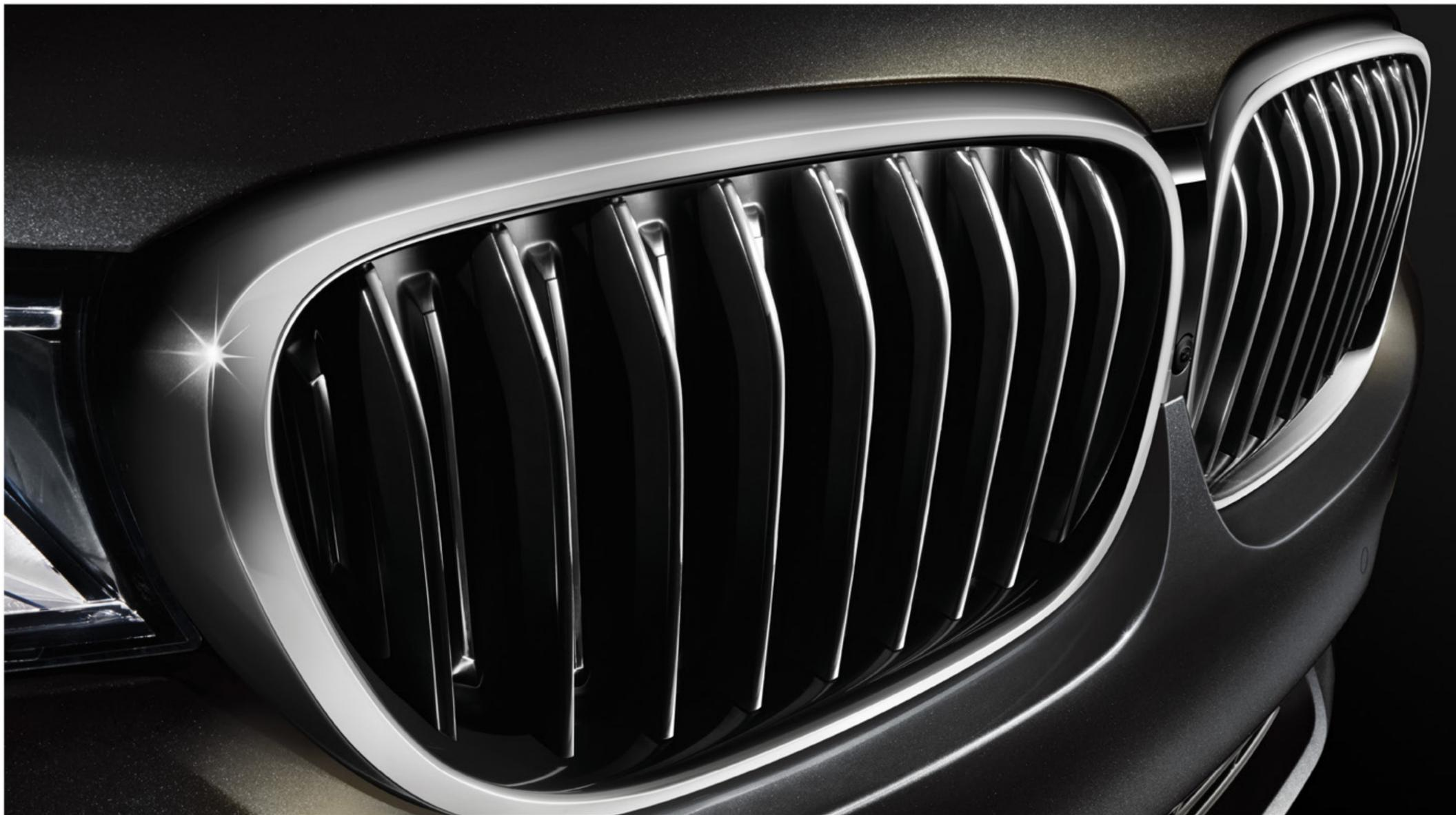
La nouvelle Série 7 de BMW est la première voiture de la marque à être dotée de la calandre réniforme active munie d'une commande visible du volet d'air. Ouvert uniquement au besoin, pour aider à refroidir le moteur, le volet demeure fermé pour améliorer l'aérodynamisme.
